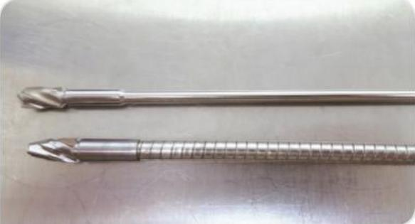
**Figura 1.** Fresa ortopédica intramedular semirrígida (acima) e fresa intramedular flexível para úmero utilizada como amostra neste estudo (abaixo).
